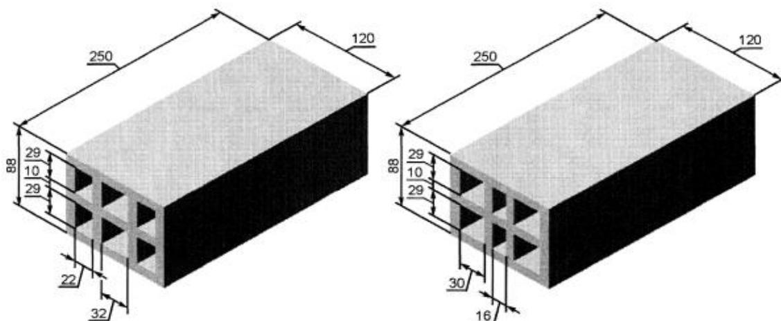
**Рисунок А. 1.17 - Кирпич формата 1,4 НФ с шестью пустотами**
