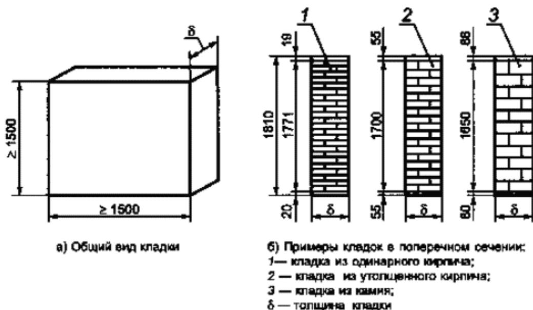
**Рисунок 2 - Фрагмент кладки для определения теплопроводности**
