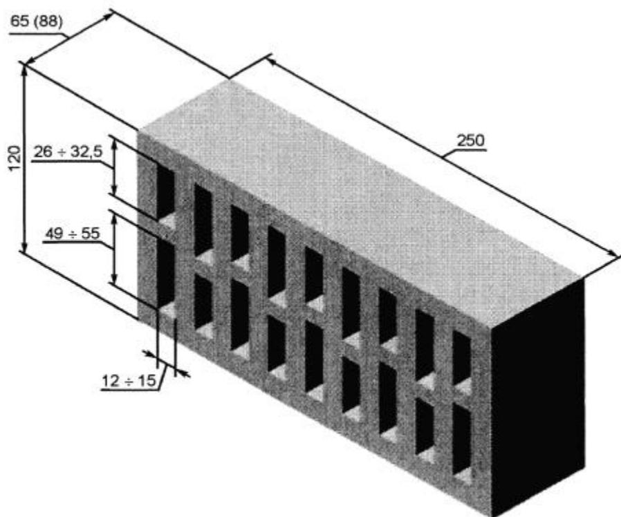
Рисунок А.1.4 - Кирпич формата 1(1,4) НФ с 18 щелевидными пустотами
